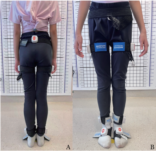
图 2 7 个传感器绑定位置示意图 A. 背面；B. 正面
